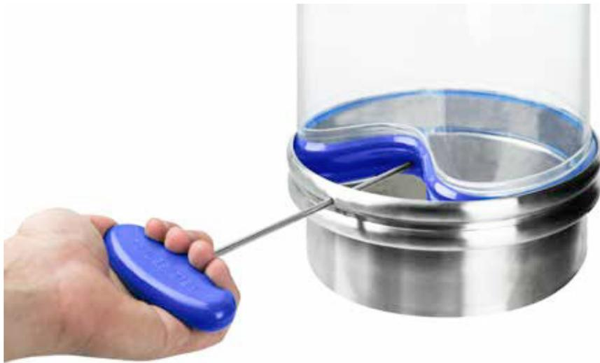
Una volta installato un connettore BFM® TR, è praticamente impossibile rimuoverlo manualmente. Tuttavia, è semplice rimuoverlo utilizzando un TR Release Tool, che viene semplicemente inserito in un foro di 6 mm sul lato di entrambi i bocchettone superiore e inferiore.
