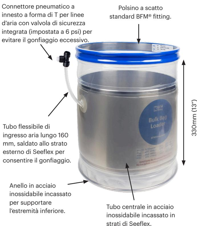
**NOTA:** Se utilizzato in Zone Polverose Atex, la tubazione di alimentazione e il raccordo di ingresso dell'aria pneumatica devono essere messi a terra.
