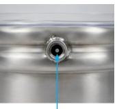
Fora un foro di diametro 3 mm (7/64") tra le scanalature del bocchettone attraverso la presa saldata.
