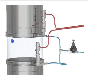
L'aria pressurizzata viene pompata tra il manicotto flessibile del connettore BFM® e il bocchettone.
