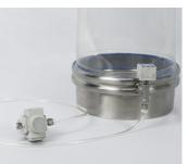
Collega il tubo dell'aria al raccordo a T.Assicurati che l'estremità contenente l'orifizio fisso sia inserita nel raccordo a T.
