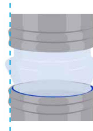
NOTA: È necessario prestare attenzione durante la saldatura per tenere conto del ritiro.
