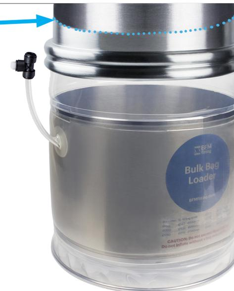
**PASSO 2:** Incastra il risvolto superiore (cuff) del BFM® Bulk Bag Loader nello spigotto come faresti con un connettore standard BFM®. (Per ulteriori informazioni sull'inserimento a scatto di un connettore BFM®, consulta il nostro documento 'Istruzioni di Installazione Facile').
